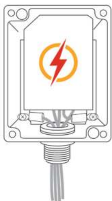
COURT-CIRCUIT CRÉÉ PAR UNE SURTENSION MAJEURE
